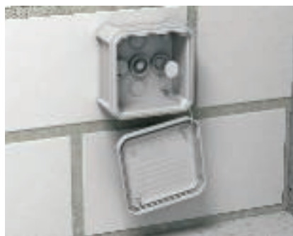
Закрепване към пода/стената Кутиите могат да бъдат закрепени през два до четири разчупващи се отвора в дъното. Отворите отново могат да бъдат затворени посредством капачки.
