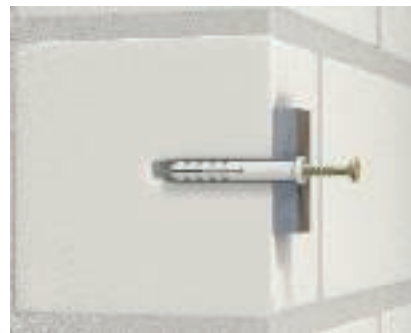
Набивен дюбел тип 910/SD Посредством набивни дюбели 910/SD се закрепват монтажни елементи при проходен монтаж в бетон или плътни тухли. Набивният дюбел е от пластмаса и се набива в комбинация с конусовиден винт. Чрез въртене на винта може да се регулира закрепването.
