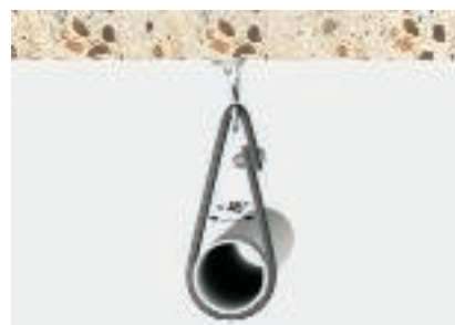
Вид натоварване 6: Лента, увита около плоска затворена кука и тръба или подобен елемент Минимален разрушаващ товар съгласно колона 2xВ
