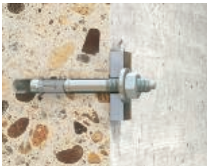
Анкерен болт тип FAZ II Анкерен болт тип FAZ II, за закрепване на елементи с големи натоварвания в армиран и неармиран нормален бетон C20/25 до C50/60, подходящ за проходен монтаж, със съединителна резба M8, M10 или M12, товароносимост 4,3 kN (M8), 7,6 kN (M10), 11,9 kN (M12). Одобрен за съхраняване на функционалността.
