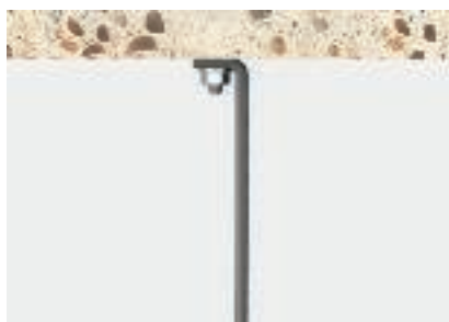
Вид натоварване 4: Завинтена посредством болт и подложна шайба към тавана Минимален разрушаващ товар съгласно колона С
