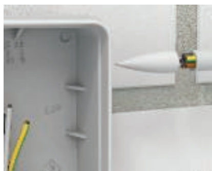
Приложение на инструмент за пробиване Поставете върха на края на проводника. След това прокарайте кабела с върха през предварително щанцованите отвори.
