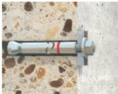
Анкерни болтове за голям товар тип FH Анкерни болтове за тежки товари тип FH с резба M12 за закрепване на елементи с големи натоварвания, товароносимост 8,26 kN.
