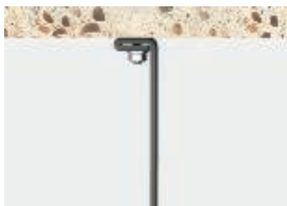
Вид натоварване 5: Завинтена посредством болт към тавана, край на лентата е сдвоен, свободният край на лентата е надолу Минимален разрушаващ товар съгласно колона В
