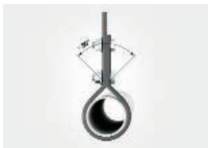
Вид натоварване 8: Тръба или подобен елемент, окачени към лента Минимален разрушаващ товар съгласно колона А
