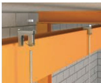
Приложение с шпилка Могат да бъдат осъществявани и други окачвания със шпилки в размери M6-M8 към стоманени трегери (завъртани трегерни клеми).
